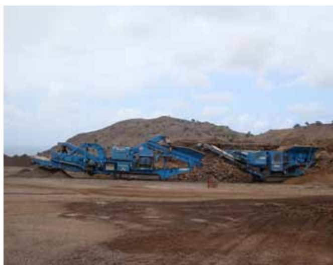
Central de Britagem na Ilha de Santiago Cabo Verde
