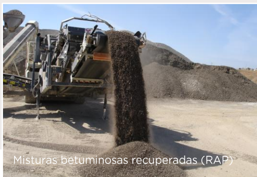
AC10 Warm mix (WMA) com 40% de incorporação de material reciclado (RAP)
